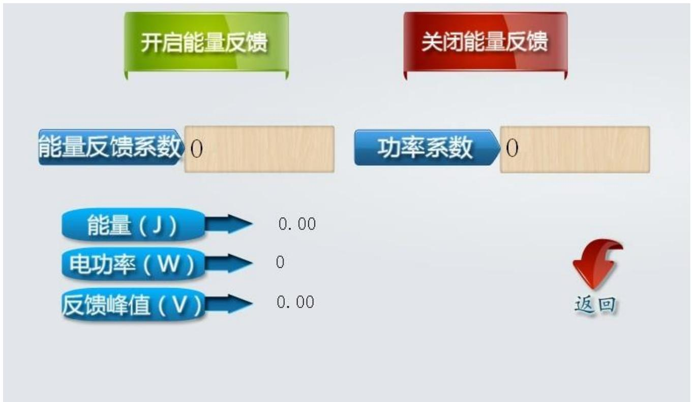
能量反馈是本产品功能之一，该界面下用户可以对能量反馈进行开启和关闭，并且对能量反馈基本参数进行编程。用户需调整能量反馈系数和功率系数两个参数，每次出光的能量值、电功率值及反馈峰值都可实时显示在下方。
