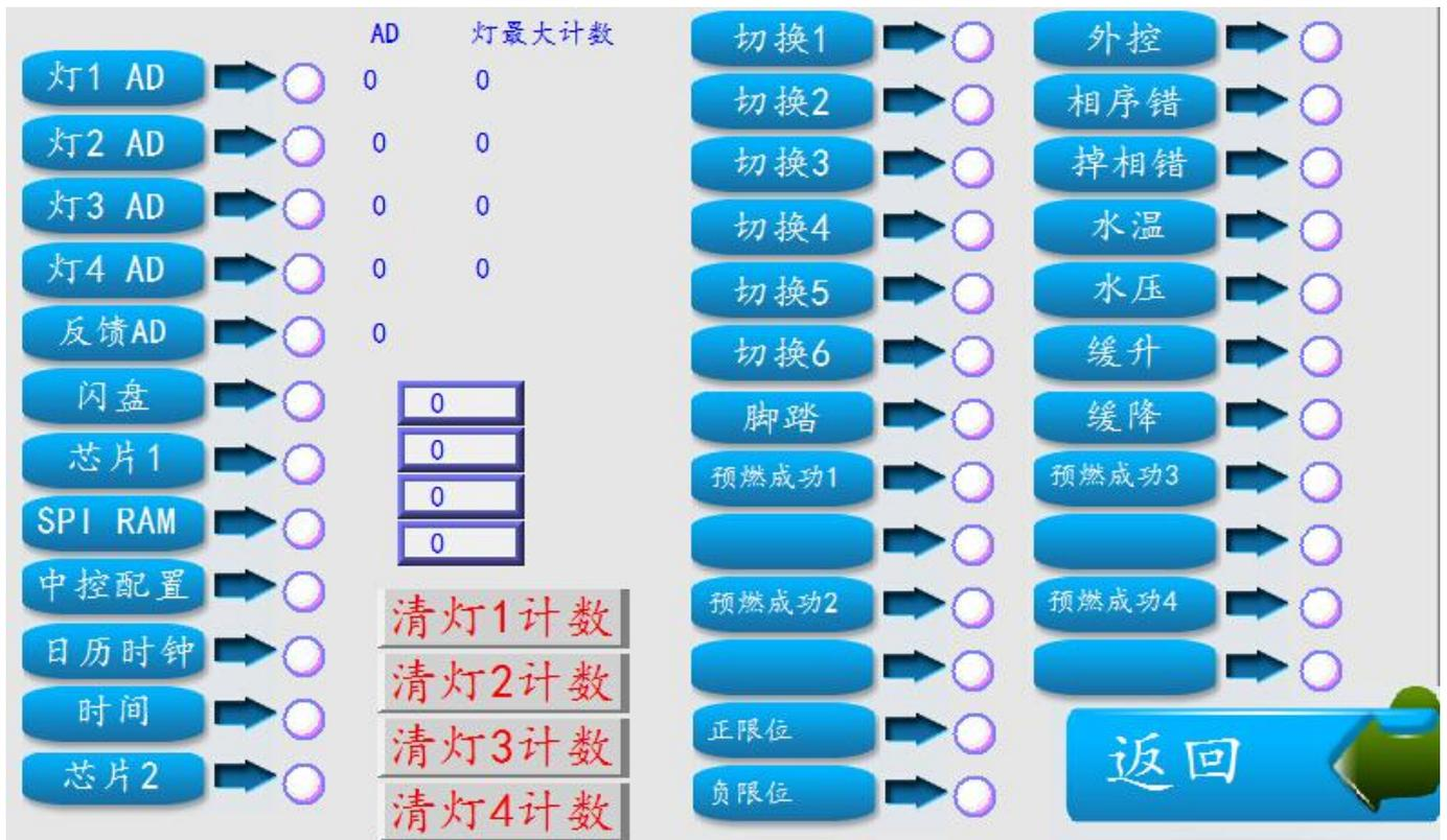
检测界面包括芯片当前状态、技术清零和信号状态，用来检测各 IO 口的输入输出情况。
